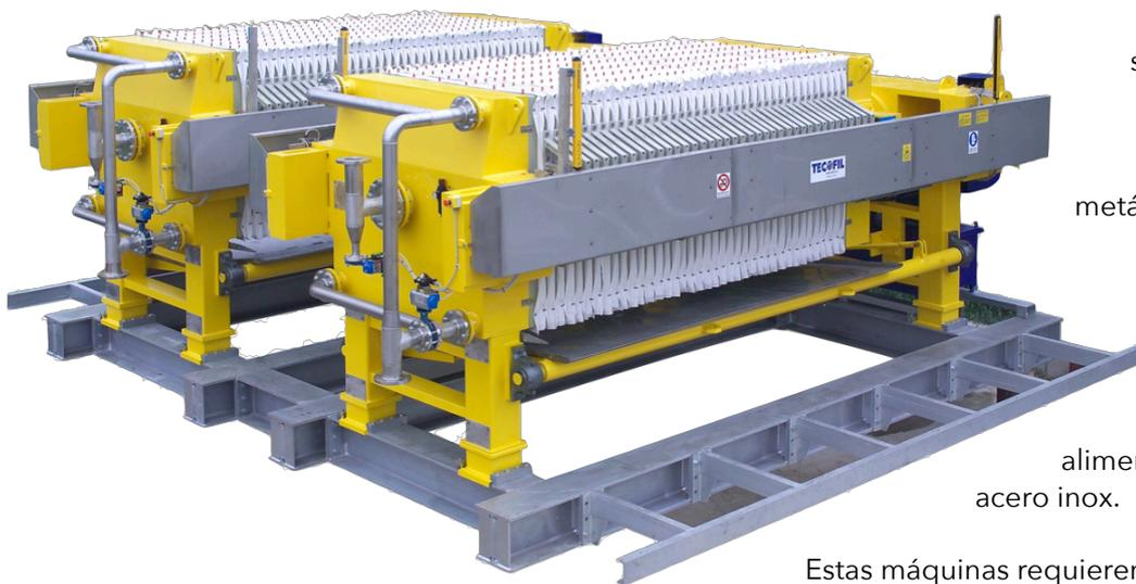
TECOFIL INTERNATIONAL selecciona el tejido de filtración ideal para cada proceso, en función de las características del lodo que se trata. La optimización del proceso puede comprender un tratamiento químico-físico, que facilite la formación de gránulos coagulados de lodo.
