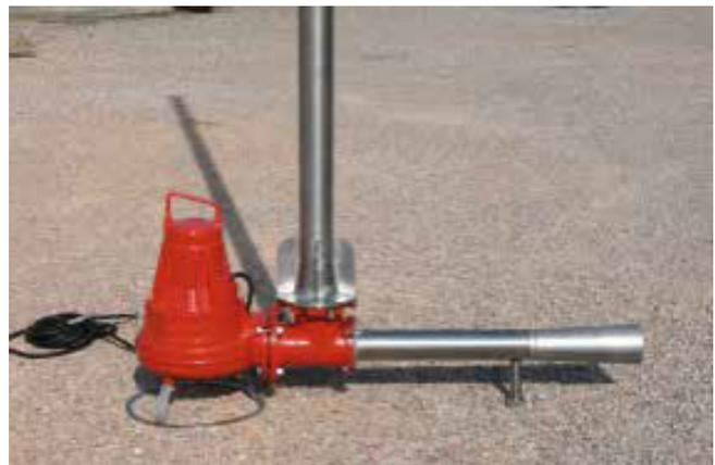
Pueden ensamblar bombas de diferentes potencias y características hidráulicas con eyectores de diferentes capacidades de flujo; en grado de satisfacer una basta gama de exigencias. Resulta una solución ideal para obtener con el mínimo de los costos un efecto combinado de aireación y agitación de aguas residuales en tanques de pequeño y mediano tamaño.
