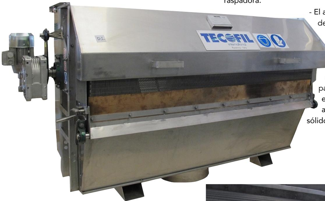
El agua entra desde una cisterna colocada en el fondo de la rejilla automática, y es obligada a atravesar la superficie cilíndrica del tambor girante, que se encuentra siempre en lento movimiento rotacional. Las partículas sólidas vienen retenidas sobre la superficie del filtro y removidas por medio de una cuchilla raspadora o por medio de un cepillo, según el modelo de rejilla.
